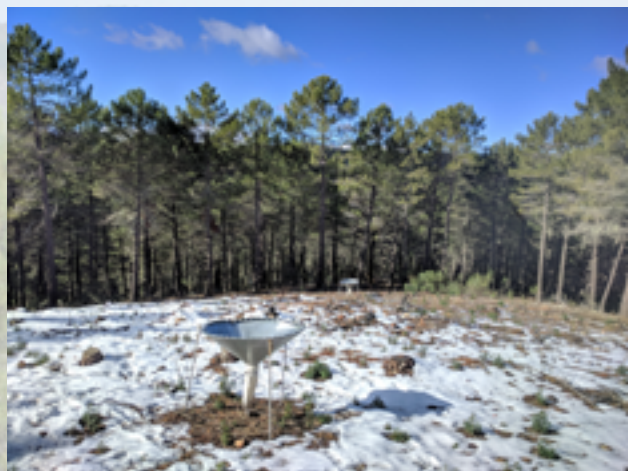
Figura 32. Colectores para la recogida trimestral del desfronde de pinocha en parcela con tratamiento de entresaca por bosquetes.
